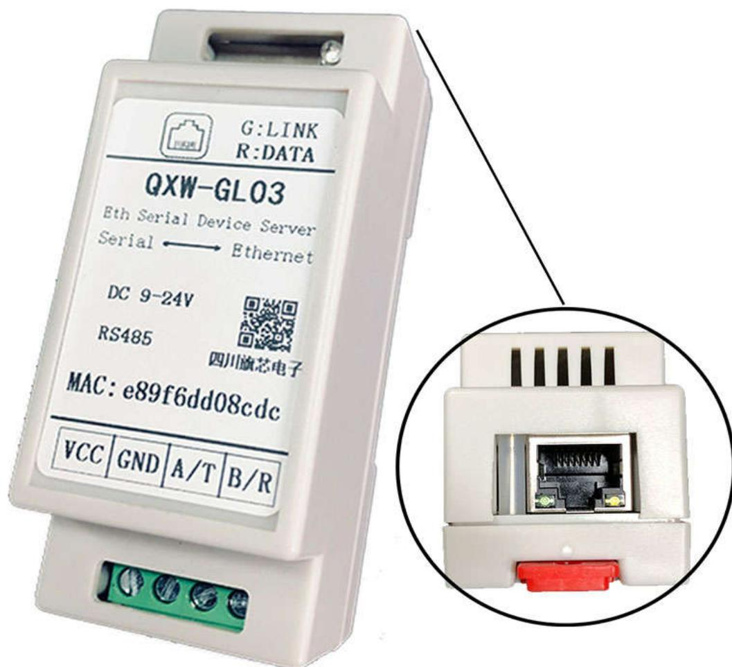
QXW-GL03 是一款专门为工业环境数据采集传输设计的 以太网转 RS485/RS232 串口服务器。实现串口设备与互联网主机之间的数据交互。具备常用的网络接口协议，适合于工业领域对各类仪器仪表、传感器进行采集控制。采用导轨型安装方式，体积小安装方便。
